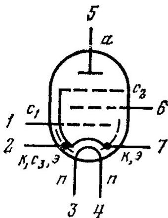
Пентоды для усиления напряжения высокой частоты в широкополосных усилителях на частотах до 300 МГц.
