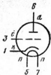
Триоды для усиления напряжения низкой частоты и генерирования колебаний высокой частоты.
