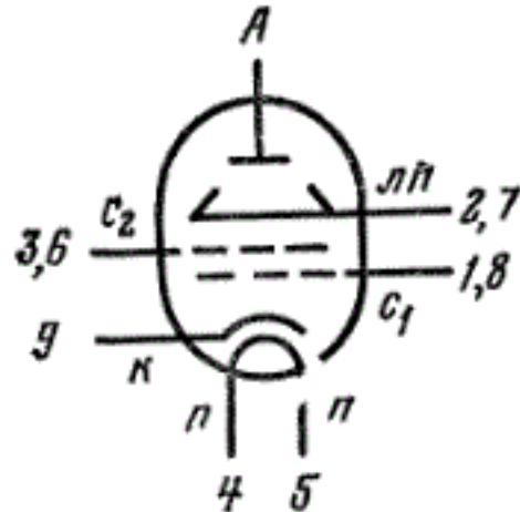
Тетрод выходной лучевой для работы в выходных каскадах строчной развертки телевизионных приемников цветного изображения с отклонением луча 110°. Оформление — в стеклянной оболочке (рис. 20С). Масса 140 г.
