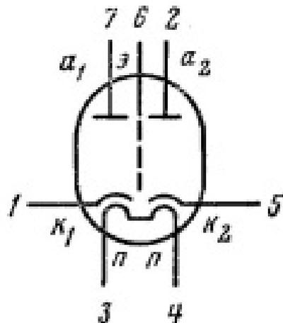
Диоды двойные для детектирования высокочастотных колебаний в схемах амплитудных и частотных детекторов, а также для работы в качестве маломощных кенотронов.
